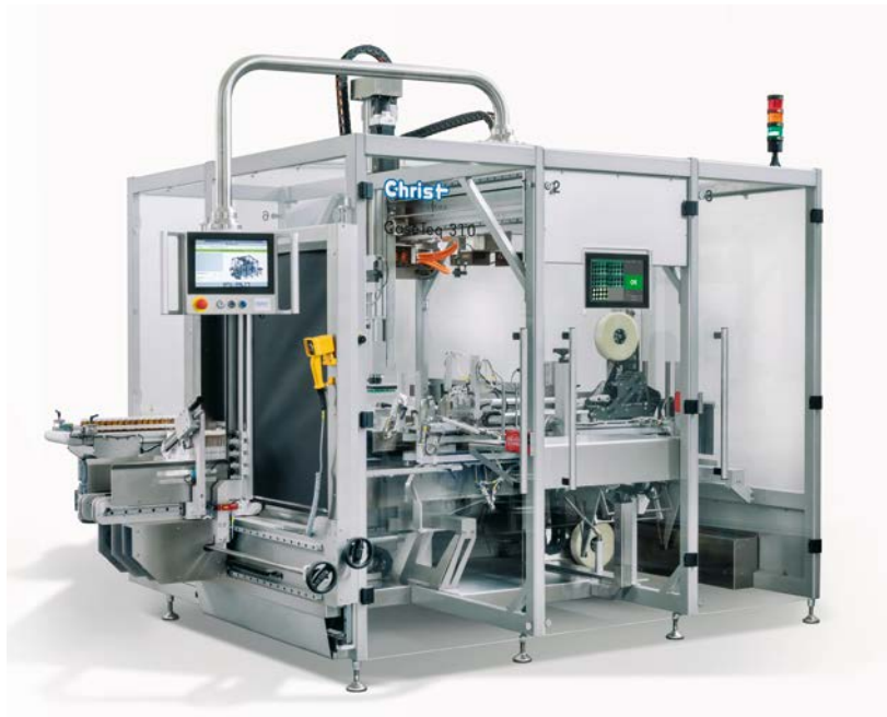
Der vollautomatische Horizontal-Casepacker CaseTeq von Christ ist eine leistungsstarke, vollautomatische Maschine zum Aufrichten, Beladen und Verschließen von vorgeklebten Versandkartons. Zukünftig übernehmen Kameras von B&R diverse Prüfaufgaben.
